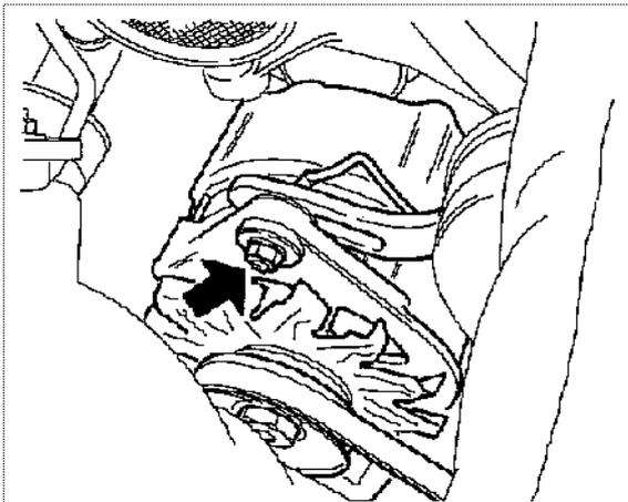
Défaire les vis de fixation (flèches) du couvercle de courroie de distribution.
